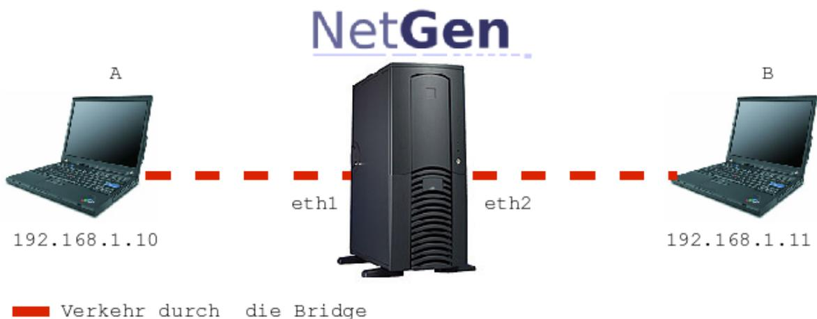
Wir prüfen nun die Funktionsfähigkeit, indem ein einfacher Ping von Rechner A auf Rechner B abgesetzt wird. Nun sollten die an NetGen angeschlossenen Rechner in der Lage sein den jeweils anderen Rechner zu erreichen.
